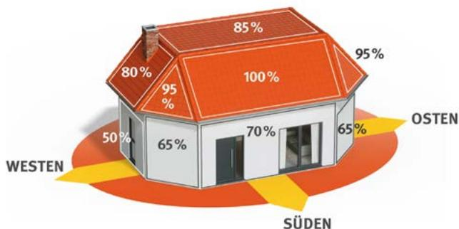
Abb. 4: Unterschiedliche Ausrichtungen der Module bringen unterschiedliche Erträge (auf 100 Prozent Maximalertrag bezogen).
